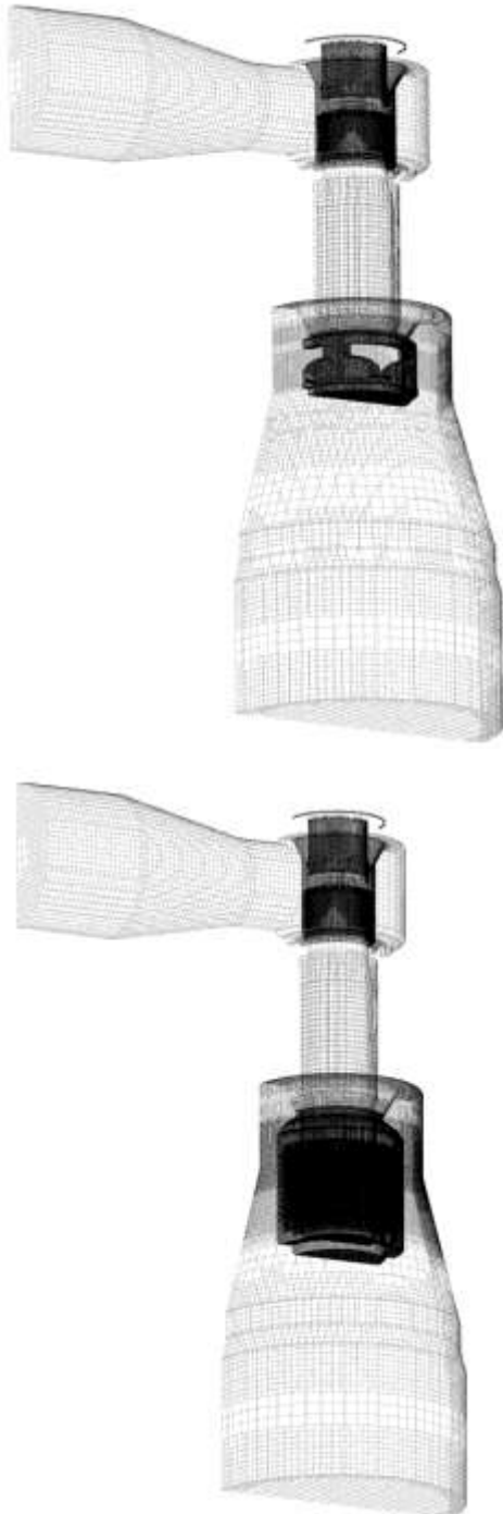
شکل ۳- شبکه بندی ناحیه جریان در شیر الف) با قفسه معمولی و ب) قفسه سوراخ دار
