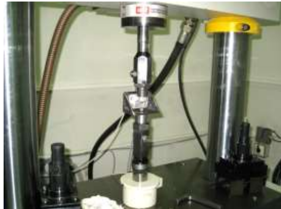
شکل ۵- دستگاه تست خستگی براکت درب هواپیما
