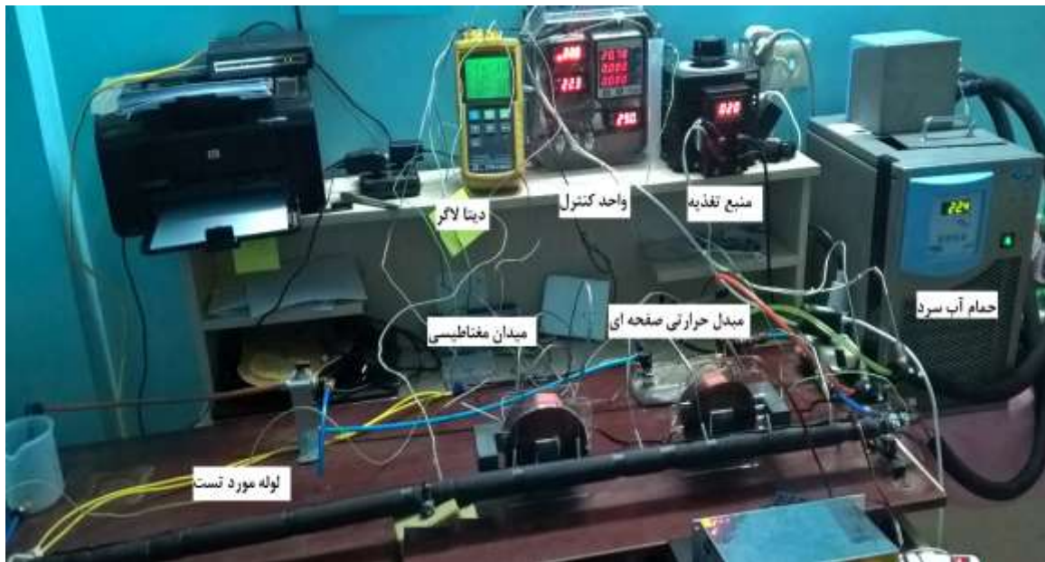
شکل ۲- تصویر دستگاه آزمایش و قسمت‌های مختلف آن
