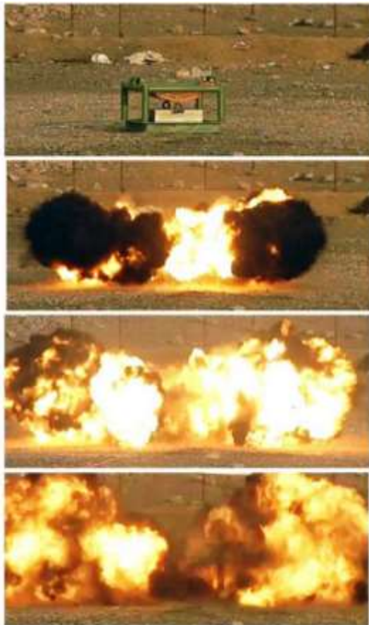
شکل ۱۱- آزمون عملی انفجار روی قسمتی از سازه بدنه خودروی زرهی ساخته شده با روش جوشکاری
