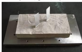
شکل ۳-ج) نحوه ایجاد ترک در نمونه
