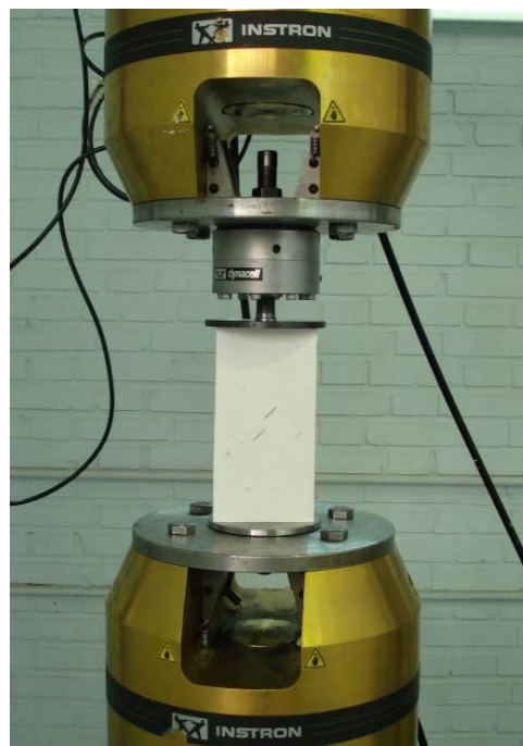
شکل ۵- دستگاه بارگذاری برای انجام تست فشاری تک-محوری بر روی نمونه‌های ترک‌دار
