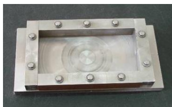
شکل ۳-الف) قالب ساخت نمونه آزمایشگاهی
