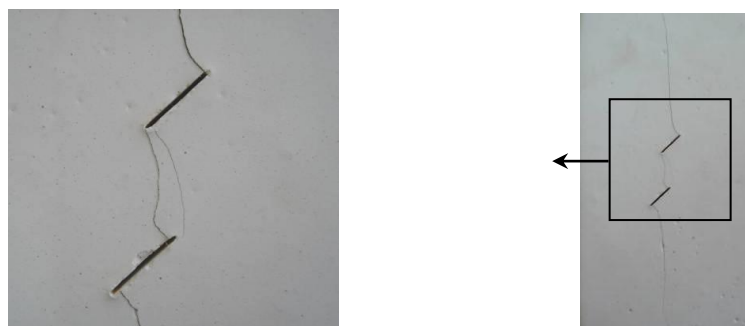
شکل ۱۱- رشد ترک‌های کششی از نوک ترک‌ها و اتصال کششی- برشی در نمونه حاوی دو ترک با شیب خط واصل ۱۰۵ درجه
