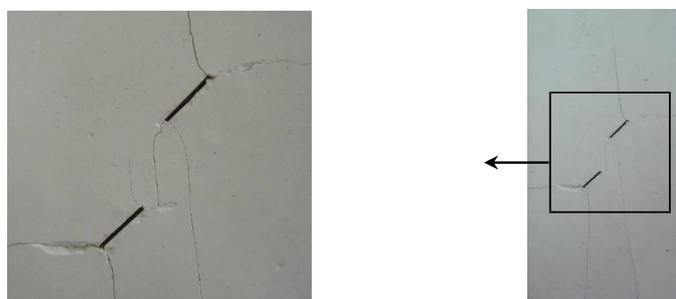
شکل ۹- رشد ترک‌های کششی و برشی از نوک ترک‌ها و اتصال برشی- کششی در نمونه با شیب خط واصل ۷۵ درجه
