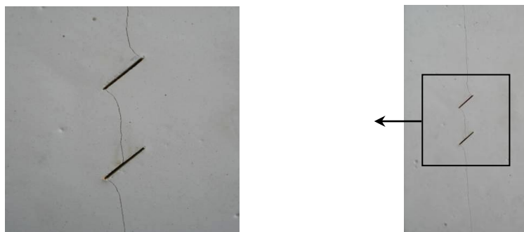
شکل ۱۲- رشد ترک‌های کششی از نوک ترک‌های اصلی و اتصال کششی دو ترک در نمونه با شیب خط واصل ۱۲۰ درجه
