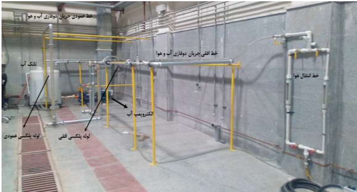
شکل ۱- حلقه تست جریان دو فازی گاز- مایع دانشگاه شهید بهشتی
