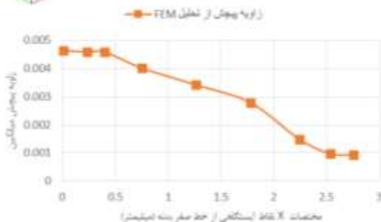
شکل ۴- توزیع جابجایی بر روی BIW در بارگذاری پیچشی
